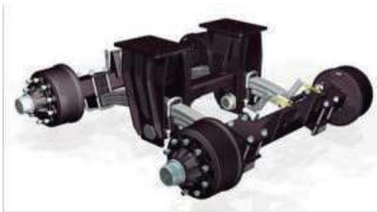
SUSPENSION BOGIE CON MUELLES Y 2º EJE AUTOMÁTICO CON BLOQUEO HIDRÁULICO
