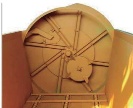
TURBINA CON TRITURADORA Y CU-
